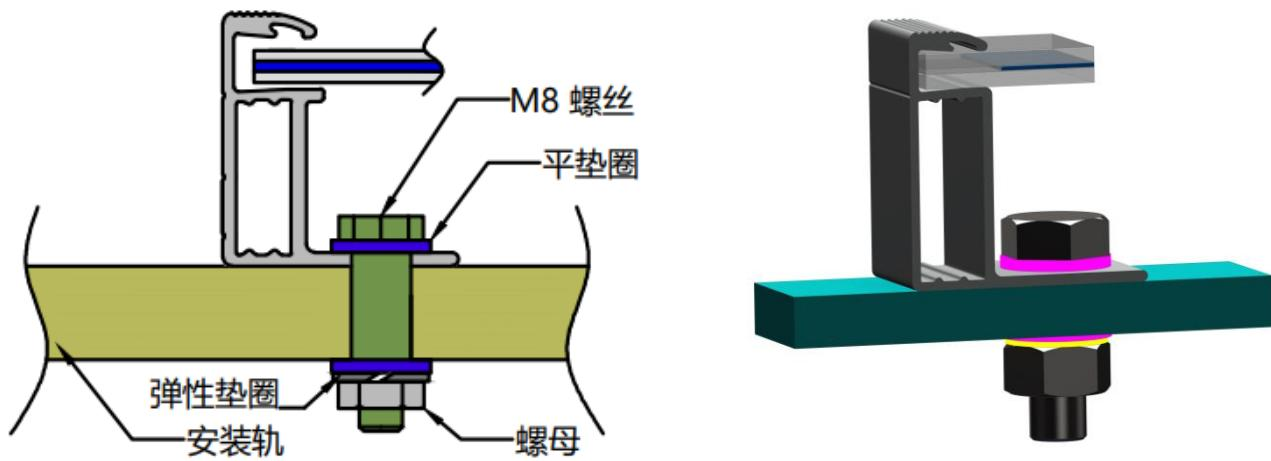
图2 螺栓安装示意图
