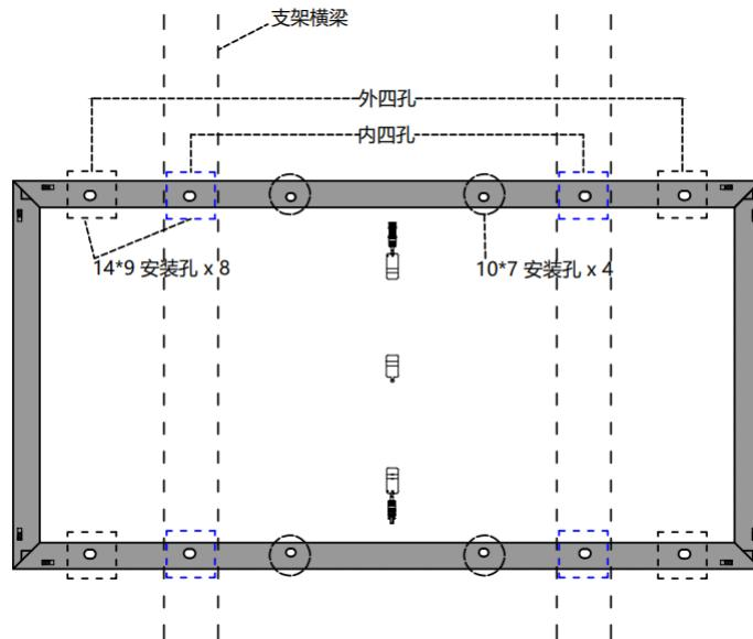
图3 螺栓安装的方式 (内4孔)
