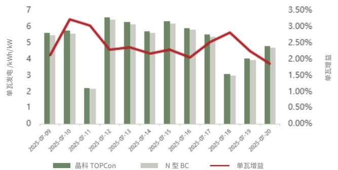
图表 2：不同日期 N 型 TOPCon 与 N 型 BC 组件单瓦发电增益对比
